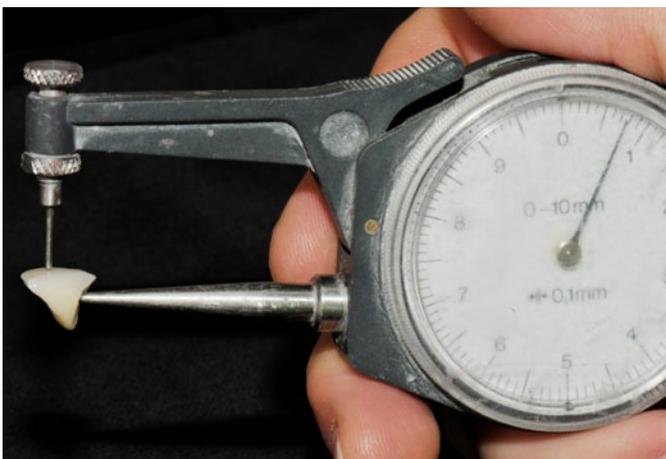
Abb. 9 In diesem Fall wurde die priti®crown auf 0,8 mm geschliffen, da sie mit einem Zirkonoxidkappchen verbunden wird. Der Hersteller schreibt eine Wandstärke von 1 mm vor.
