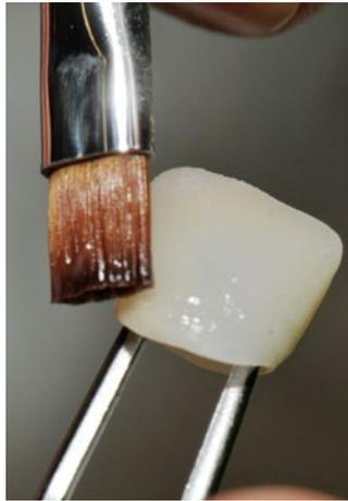
Abb. 12 Vor dem Glanzbrand kann Glasurmasse aufgetragen werden. An Stellen, an denen Malfarbe verwendet wird, ist Glasurmasse als Schutz notwendig.
